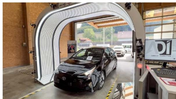
Mit dem Hagelscanner, den die TDC bereits seit 10 Jahren in Zusammenarbeit mit der Xpertcenter AG einsetzt, lassen sich Hagelschäden effizienter bearbeiten.
